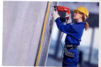
Mit dem praktischen „PowerBelt“-Akkugürtel lässt sich das Gewicht des „ACH 24“ von Flex um mehr als ein Drittel verringern.
