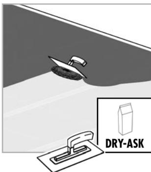
Optioneel: Bij toepassing in vochtige of natte ruimtes kan een afdichting gebeuren in combinatie met keramische bekledingen en het systeem LUX ELEMENTS®-DRY... **Alternatief, voor volledig gebruik als natte ruimte** – druk de af dichtingsfolie DRY-DF over het volledige oppervlak in de lijm (naden moeten 75 mm overlappen). Luchtballen vermijden, droogtijd: ca. 8 uur! Daarna: **1.** overlappen vastlijmen met af dichtplamuur DRY-ASK en **2.** naden plamuren.
