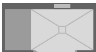
CAB-R 1780/950 L.LG * Deur DIN links / Zitbank links van de deur / Installatiewand tegenover de deur
